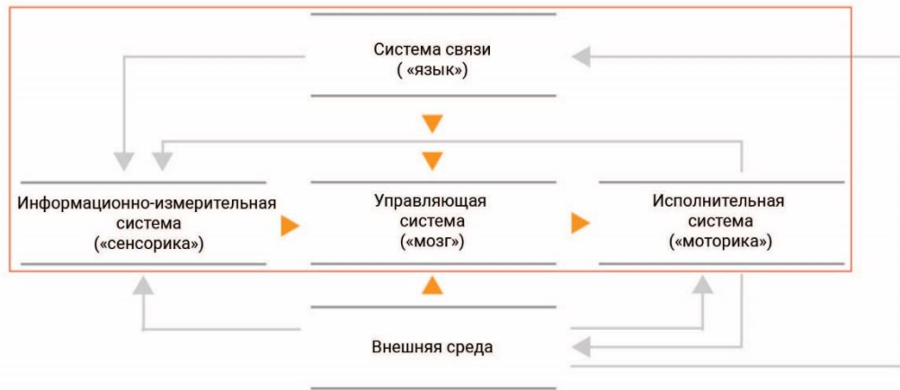
Рисунок 2.17 – Структурно-функциональная схема робота
